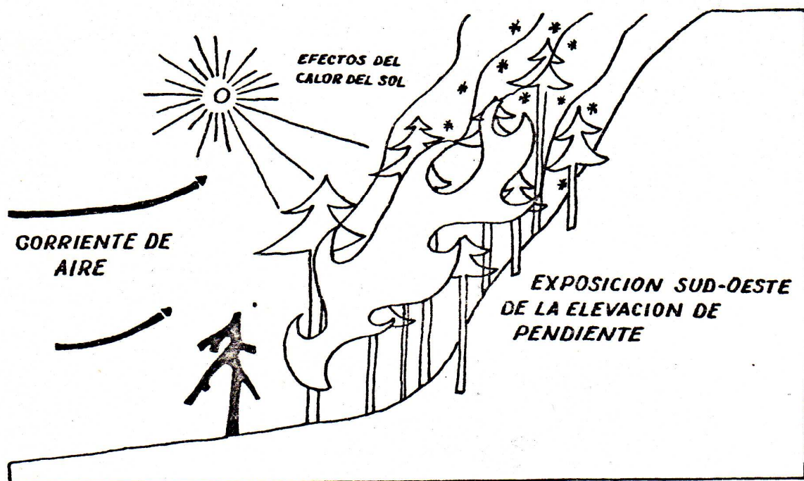
FIGURA 13 EFECTOS DE LA TOPOGRAFIA DEL TERRENO EN EL COMPORTAMIENTO DEL INCENDIO
