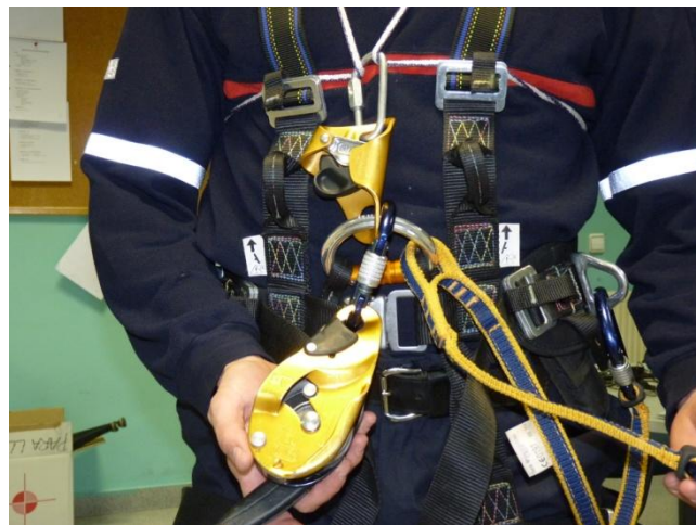
Forma correcta de colocar los aparatos en el arnes: (croll a la derecha, I'D en el centro y cabos de anclaje a la izquierda). Colocar siempre en la zona circular del maillón.
