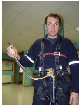
Los cabos de anclaje se fijan directamente al maillón sin mosquetón.
