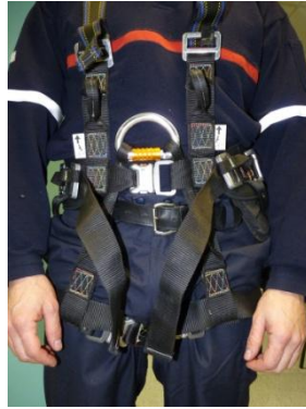
Modo de colocación del maillón al arnes
