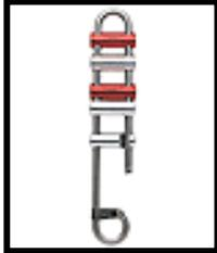
**Descendedor Rack.** Aparato utilizado para grandes descensos, muy útil en rescates, pero por la complejidad en su uso ha sido relevado por los 8's. Consta de cilindros apostados en una guía, que juntándolos o separándolos, aumentan o disminuyen su capacidad de frenado.
