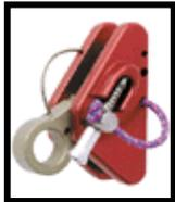
**Bloqueador Rescue Cender.** Este modelo de última generación, consta de leva dentada y se utiliza en cuerdas de 9 mm a 13 mm, ideal para rescate. Existen versiones que se utilizan para cuerdas de 6 mm a 19 mm.
