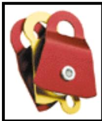
**Polea Twin.** Polea de rescate doble, cuyo orificio superior da cabida hasta tres mosquetones. Consta de una roldana de 51 mm que permite cuerdas inferiores a 13 mm. Es ideal para sistemas de poleas y trabajo en espacios confinados.
