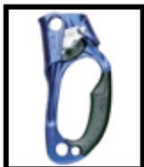
**Bloqueador Ascensión.** Solamente para uso personal y deportivo. Este es un puño para ascenso en cuerda fija. Tiene versión mano derecha e izquierda y consta de una leva dentada. A cargas extremas, tienden a rasgar el forro de la cuerda.
