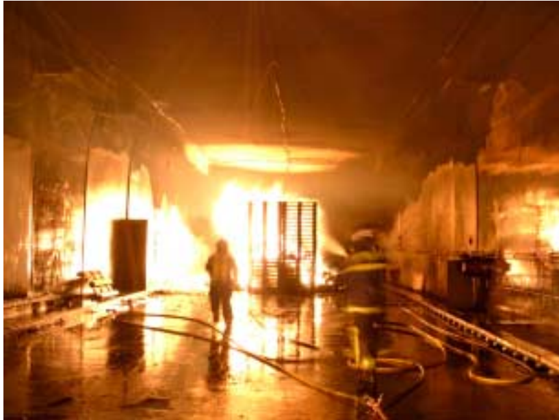
Figura 7: Ensayo de incendio en el túnel experimental de San Pedro de Anes, con ventilación longitudinal. La imagen muestra la situación aguas arriba del fuego
