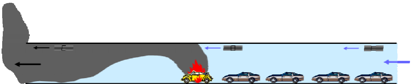
Figura 6: Evolución de los humos con ventilación longitudinal
